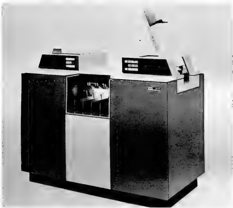
צ'ור 13—6. מנקבת כרטיסים מהירה (300 כרטיסים לדקה) דורשת איחסון של כרטיס פלא (80 תוים) לפני התחלת הניקוב. המהירות מושגת על חשבון מחיר ומורכבות. בתצלום דגם IBM 2540.
